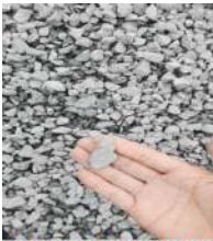
劣质骨料 Некачественный заполнитель
